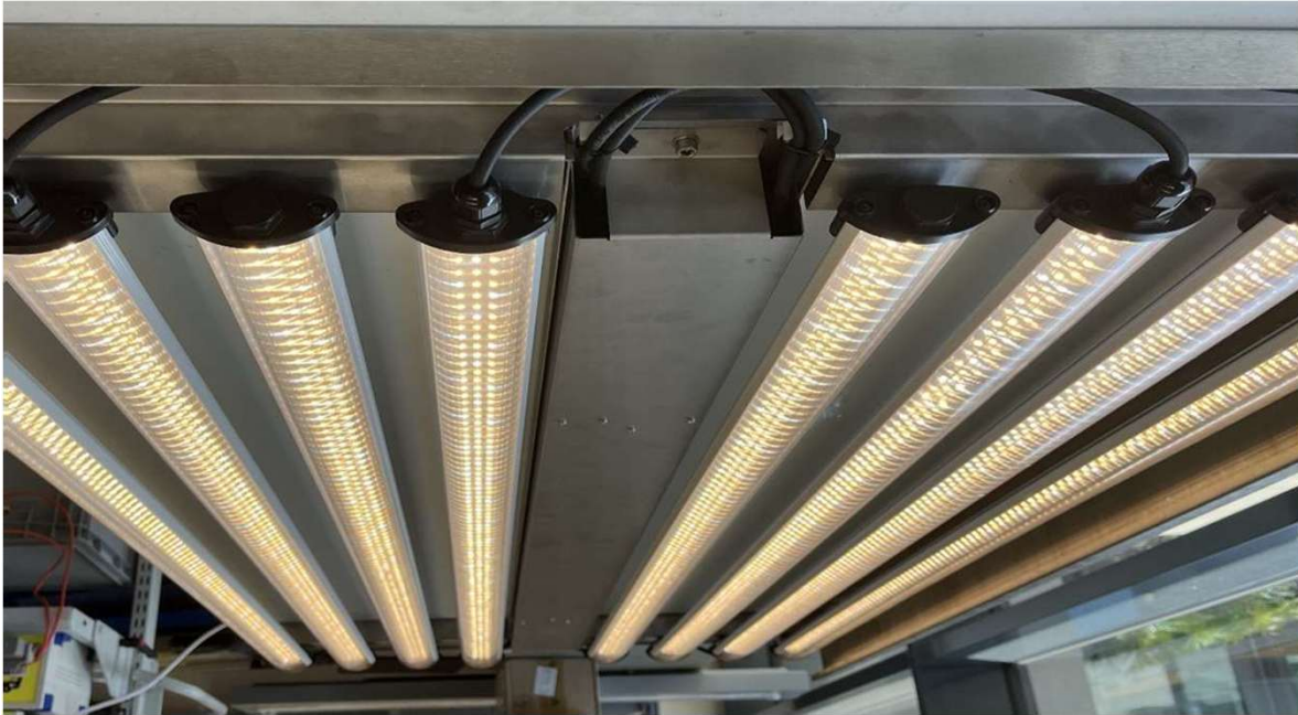
Abb.2: LIPA-Umrüsteinheit für Fachböden einer Klimakammer mit clipsbarer Lybra-Leuchte
